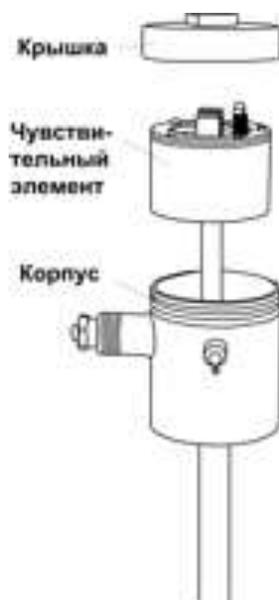
**внешней – "оболочки"**, состоящей из корпуса с крышкой, и приваренной к нему трубы - направляющей, по которой свободно перемещаются поплавки в пределах ограничителей - хомутов, закрепленных на направляющей;
