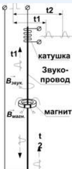
Измерение уровня преобразователем ПМП-201 основано на эффекте магнитоstriction - возникновении механической деформации длинного тонкого ферромагнитного стержня (звукпровода) под воздействием двух магнитных полей:
