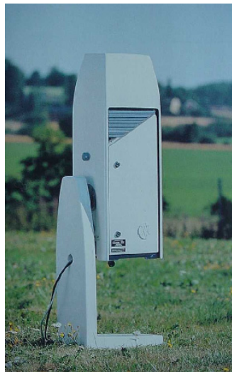
Рисунок А.21 — Датчик высоты облаков СТ25К
