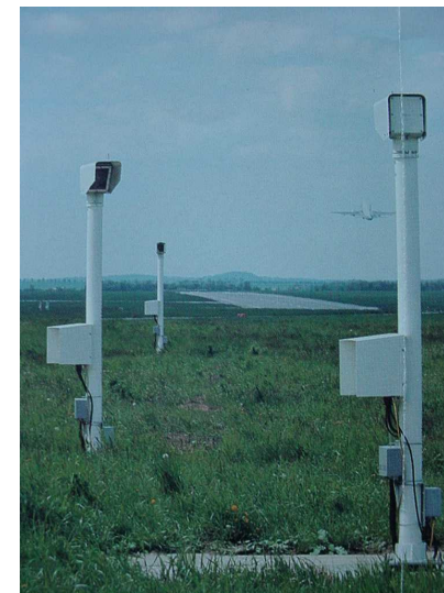
Рисунок А.22 — Трансмиссомер ИДВ MITRAS
