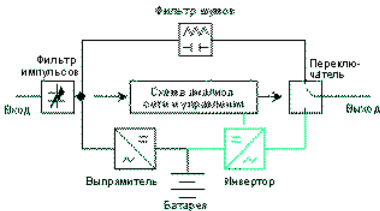
Рис. 9. Работа ИБП с переключением от сети
