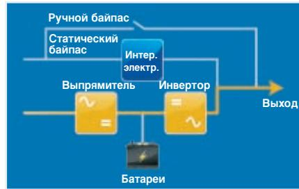
В случае ухудшения характеристик внешней электросети и выхода наблюдаемых параметров за допустимые границы, система переходит в режим максимального управления электропитанием, обеспечивая нагрузку качественным электропитанием и используя для этого режим двойного преобразования с КПД 95%.
