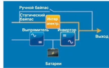
Если к ИБП подключена нелинейная нагрузка, для которой характерны гармонические колебания, **Trinergy** может выполнять выравнивание характеристик, работая как активный фильтр, и потребляя лишь необходимое количество энергии для компенсации помех на линии, что позволяет достичь максимального возможного КПД - от 96 до 98% в зависимости от вида имеющихся помех.
