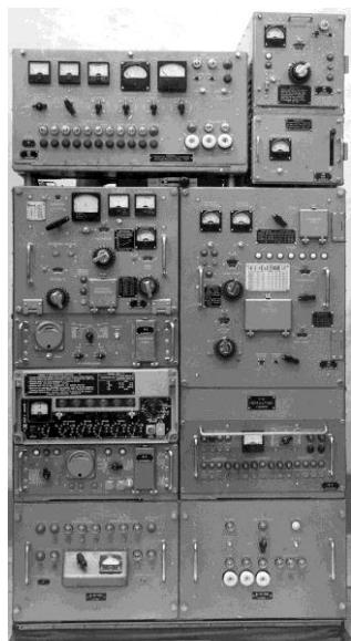
Распределительная часть аппаратуры передачи данных (АПД) обеспечивает прием и передачу фазирующей, контрольной и боевой информации и предназначена для преобразования последовательного кода информации в параллельный и пословного ввода информации из каналов связи в управляющий вычислительный комплекс, а также для обратного преобразования информации при выдаче ее из управляющего вычислительного комплекса.
