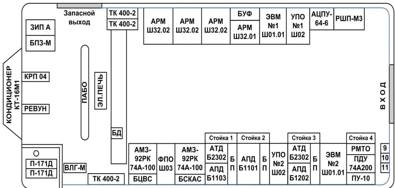
Управляющий вычислительный комплекс (ВК) предназначен для автоматизации решения основных функциональных и расчетных задач. В состав управляющего вычислительного комплекса входят:
